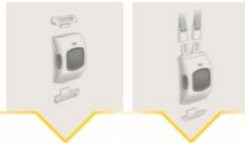
Entfernen Sie das elastische Armband. Anschließend nehmen Sie die, auf beiden Seiten gelegenen, Armbandhalter raus, indem Sie sie nach oben schieben und dann rausziehen.
