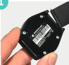
Entfernen Sie auf beiden Seiten des Armbands den jeweiligen Metallstift, indem Sie diesen leicht eindrücken und im Anschluss vorsichtig herausziehen.
