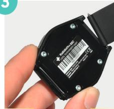
Nun stecken Sie den Stift in das Loch im Gehäuse des Notruftknopfs auf einer Seite hinein. Der Stift ist an beiden Enden versenkbar, damit das Armband einfach und schnell montiert werden kann. Sollte der Stift sich nicht in das Gehäuse führen lassen, muss auch das andere Ende des Stifts ein wenig eingedrückt werden.
