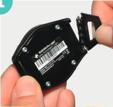
Lösen Sie die Befestigung der Halskordel, indem Sie den Metallstift vorsichtig entfernen. Bitte beachten Sie, dass beide Seiten des Metallstifts versenkbar sind.
