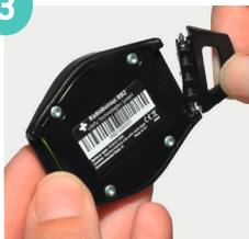
Nun stecken Sie eine Seite des herausstehenden Metallstifts in das Gehäuse des Notrufknopfs und montieren die Befestigung an den Notrufknopf.
